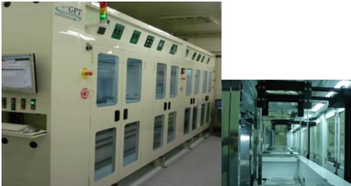
圖12、弘塑科技設計製作之高溫磷酸濕式蝕刻自動化量產設備。
