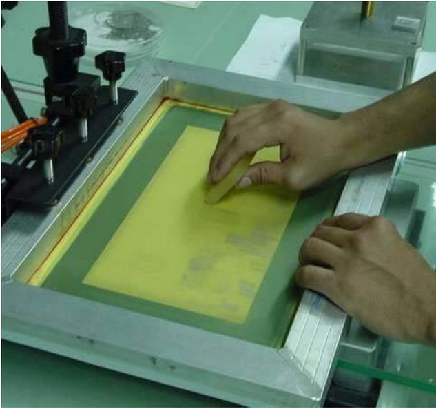
圖 6.11 網版印刷結構膠
