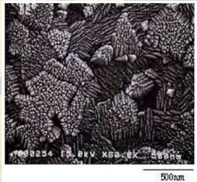
ITO 的原子与晶粒排布（电子扫描）
