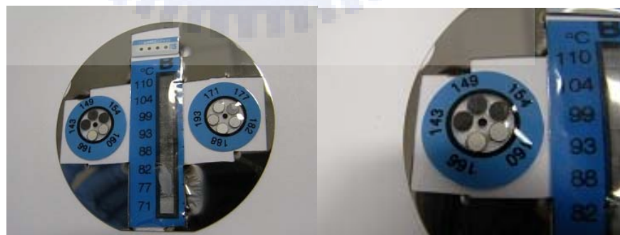
圖 47 DLC 材料生長溫度測試
