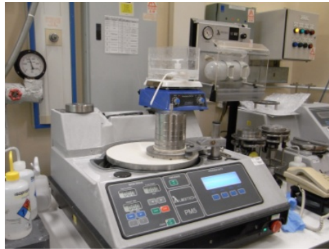
圖 34 Logitech PM5 CMP 設備
